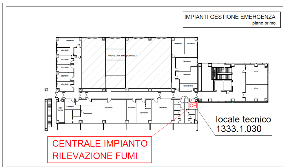
Figura 1. Ubicazione impianti gestione emergenza.
